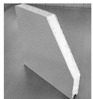
を独自開発し、従来の外壁よりも機密性・遮音性・耐久性に優れた環境ハウスをご提案しています。これは耐熱パネル鋼板を使用した外壁と内壁の間に、硬質発泡ウレタンを注入し、一枚の壁材にしたもので、中の発泡ウレタンの厚さだけでも四三ミリあります。ですが、発泡ウレタンですから重くならず、従来のプレハブハウスと同じ工法で建設出来ます。価格は少し上がりますが、主流になりつつある商品です。
